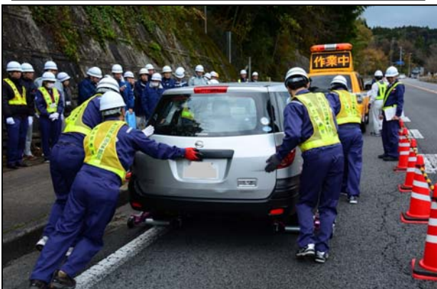
車両簡易移動器具による放置車両の移動
