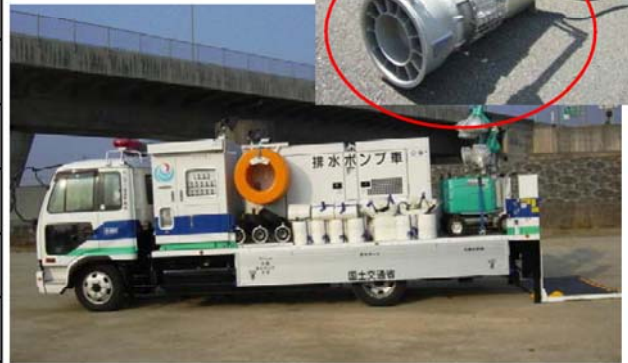
排水ポンプ車写真
