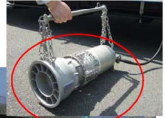
排水ポンプ単体→
