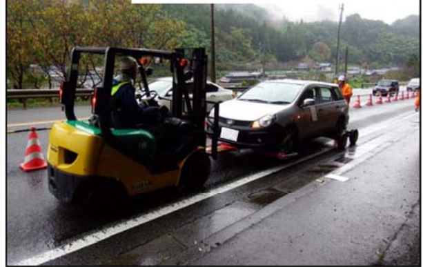
フォークリフトによる車両移動
