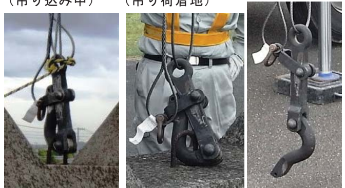
①ロック状態 ②ストッパー解除 ③フック開放 (吊り込み中) (吊り荷着地)
