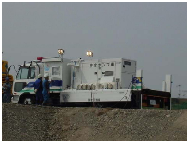
写真－１ 排水ポンプ車
