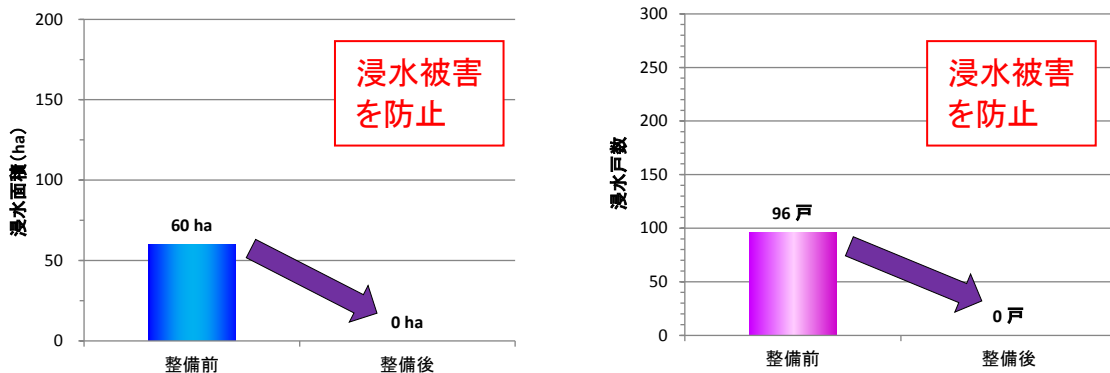
図- 8.5 平成 26 年台風 11 号に伴う洪水時の洪水氾濫の防止効果
