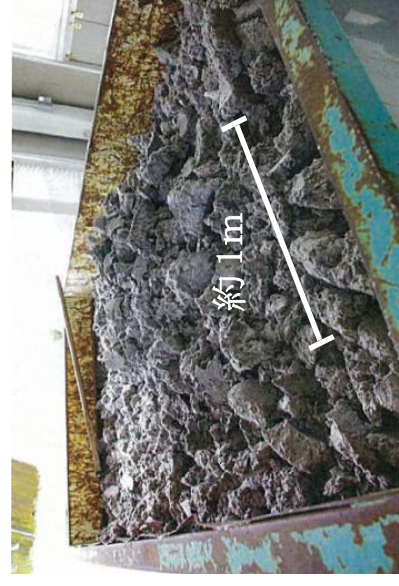
2日分の脱水堆積物（コンテナ 1 杯分（約 2 t））
