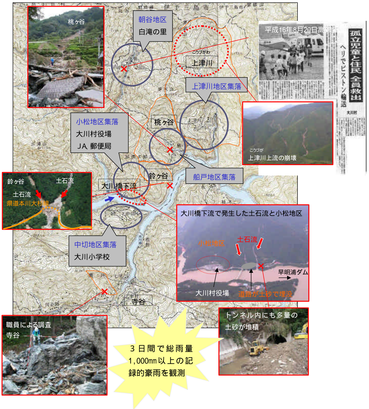
図-5 平成16年8月の台風15号豪雨による被害状況
