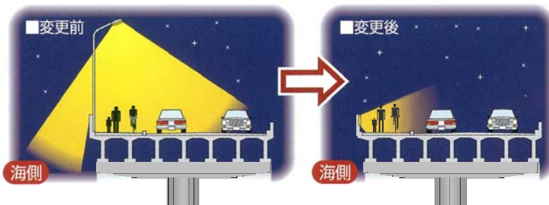
壁高欄に埋め込んだ照明の点灯試験
