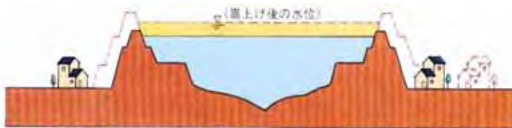
堤防の嵩上げ
