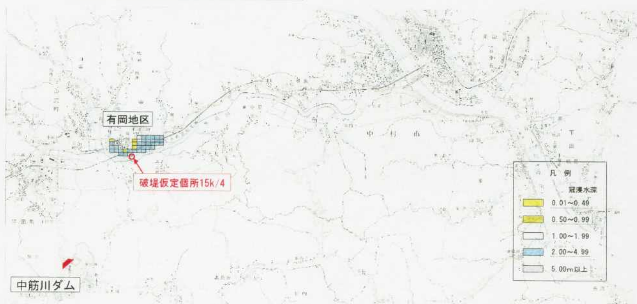
中筋川ダムがない場合の氾濫状況
