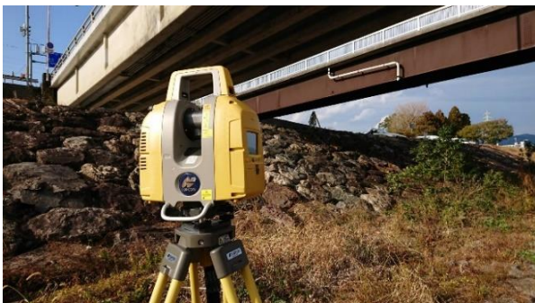
レーザー測量の実施【点群による3Dプリンタの形状イメージの取得】
