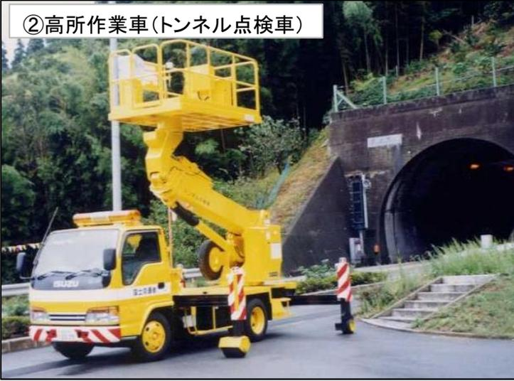
・高所作業車(トンネル点検車)は、普通の高所作業車に比べ、大型のゴンドラを有しており、より効率的に作業を行うことができる建設機械です。
