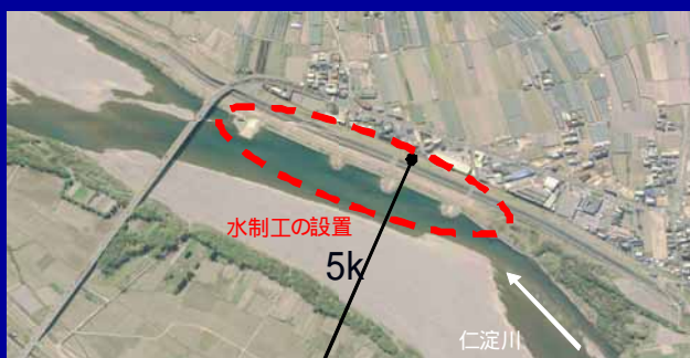
水衝部の対策状況
