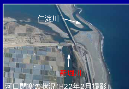
河口部の維持管理 (河口砂州の開削状況)
