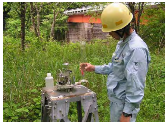
水文観測施設の点検状況（雨量）
