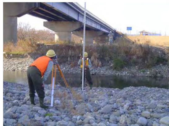
河川縦横断測量状況
