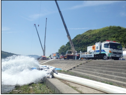
【排水ポンプ車操作訓練状況(仁淀川左岸の仁西地先高水敷)】
