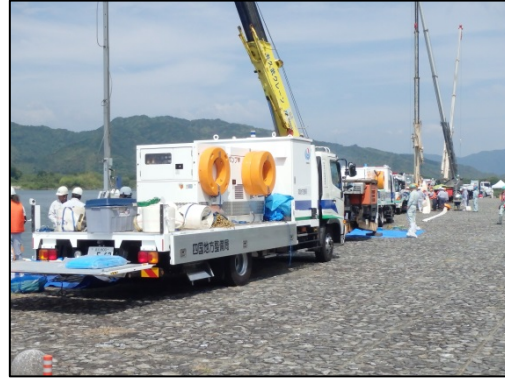
【排水ポンプ車操作訓練状況(仁淀川左岸の仁西地先高水敷)】
