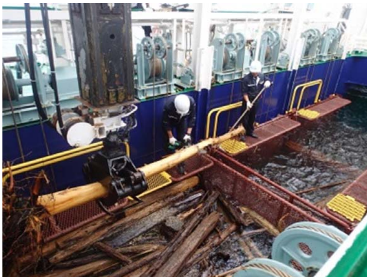
回収した流木の切断状況
