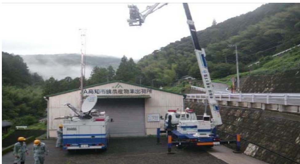
●衛星通信車と照明車の設営
