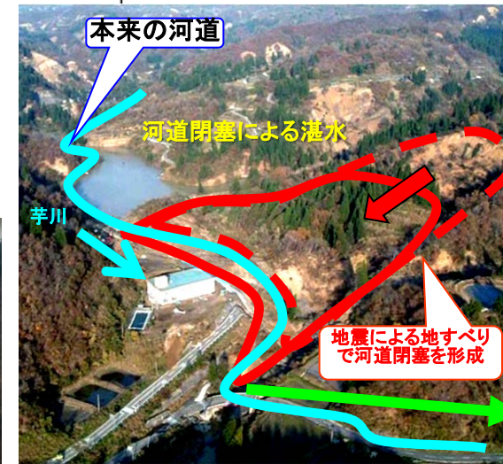
新潟県中越地震により発生した地すべりによる河道閉塞形成状況(新潟県長岡市)
