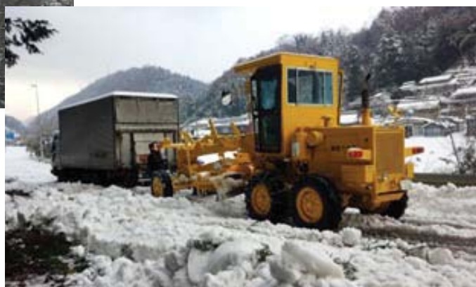
除雪車により車両を牽引
