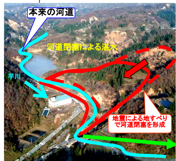
新潟県中越地震により発生した地すべりによる河道閉塞形成状況(新潟県長岡市)
