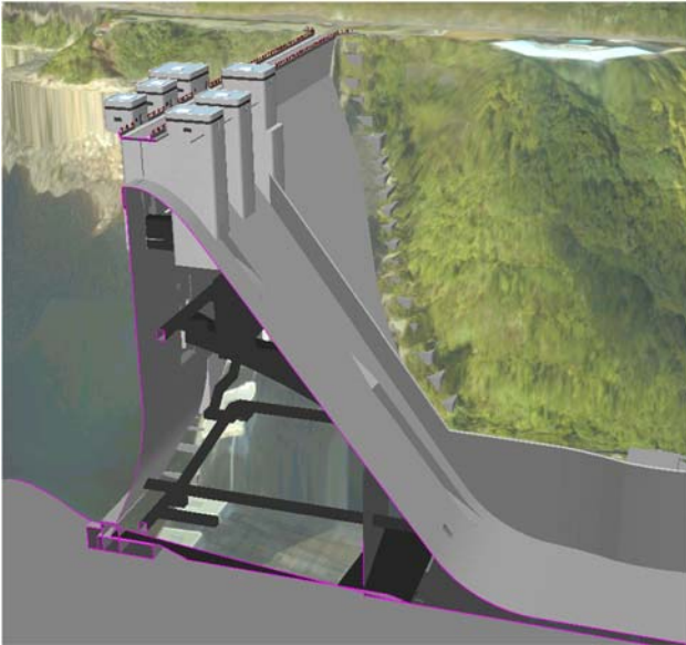
図-5 設計図を元にモデル化（富郷ダム）
