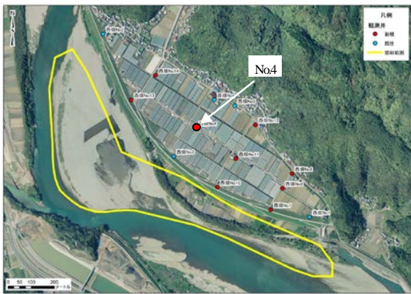
図-3 観測井No.4の位置および河道掘削範囲(黄色枠内)
