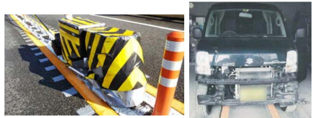
写真-4 ノックスクッション・車両損傷状況
