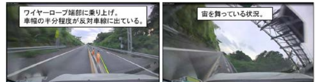
写真-2 ワイヤロープ端部への乗り上げ事故状況
