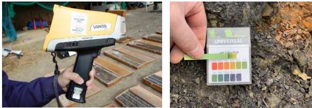
ハンドヘルド型蛍光 X 線分析装置 簡易酸性化可能性試験
