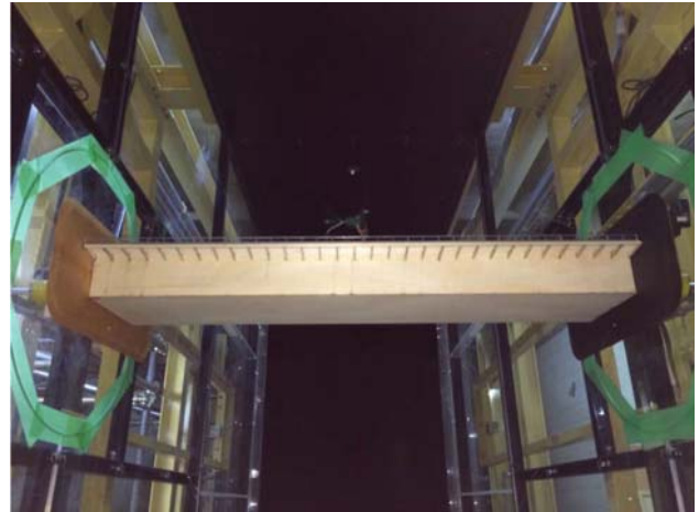
図-7 風洞実験中の模型
