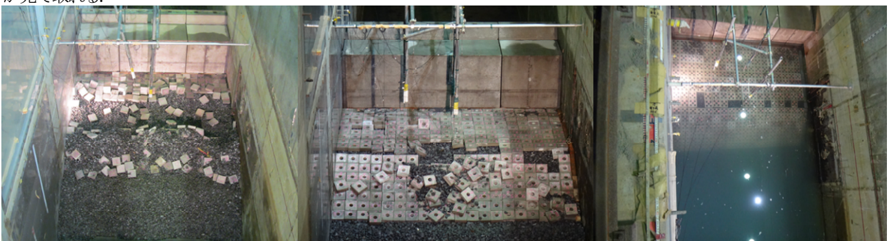
図-10 実験時の被覆ブロックの散乱状況(左:空隙率0% 中:空隙率8% 右:空隙率24%)
