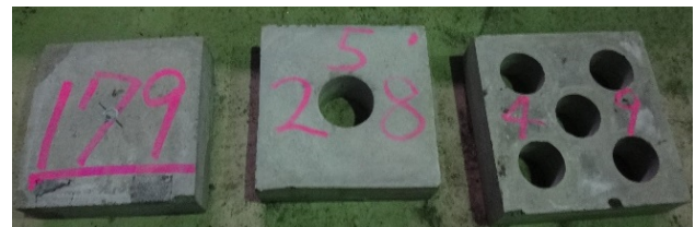
図-4 実験模型写真(被覆ブロック)
