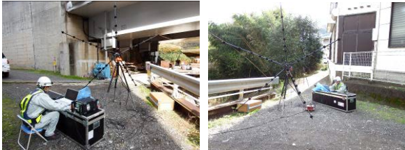
写真-1 ビームフォーミングによる調査状況
