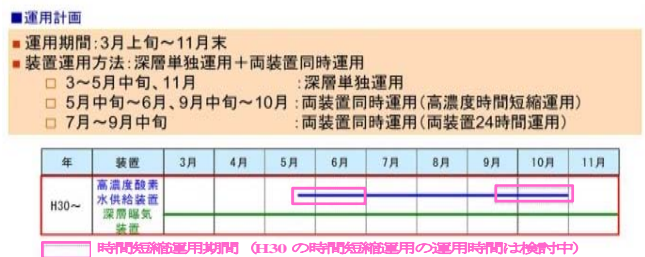
図-8 深層曝気装置、高濃度酸素水供給装置の運用ルール
