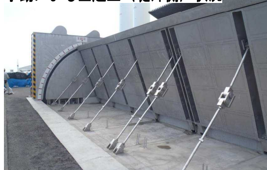
図-13 現場試験状況（上:起立開始、中:全起立（堤内側）、下:全起立（堤外側））
