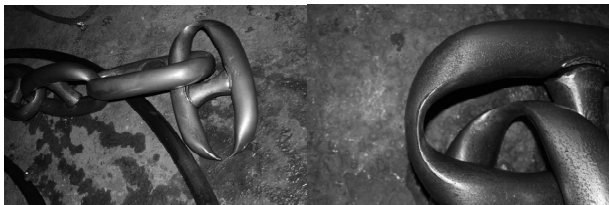
写真-2 破断したチェーンの状況 (No. 77リンク)
