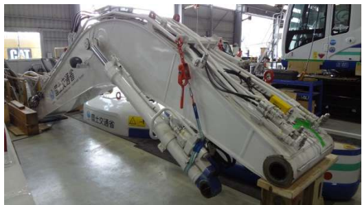
写真-4 分解組立型バックホウの分解状況(2)
