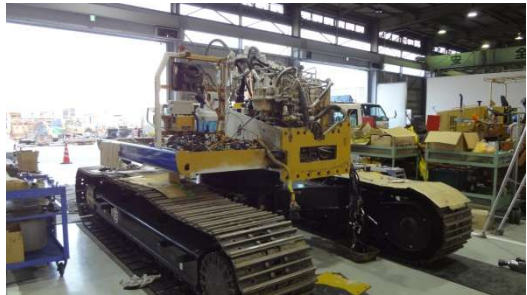
写真-3 分解組立型バックホウの分解状況(1)
