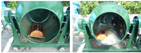
図-9 摩耗試験状況
