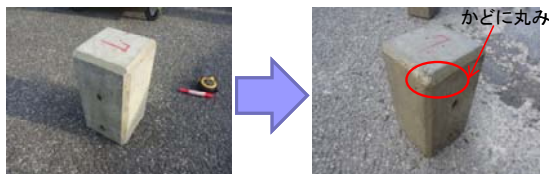
図-12 試験後の状況（コンクリート材）
