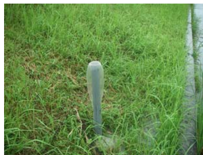
写真-2 洪水時の観測孔における地下水噴出（平成21年8月台風9号）
