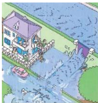
排水機場がないと 水があふれる
