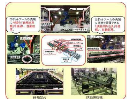
鉄筋組立自動化システム『ロボタラス』の開発 【三井住友建設株式会社】
