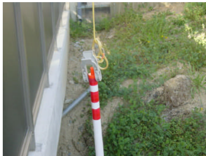
写真：橋梁浮子投下装置の例 2
