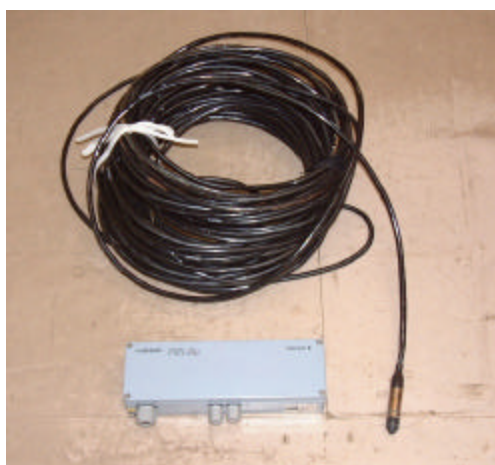
写真：安価な水圧式水位計
