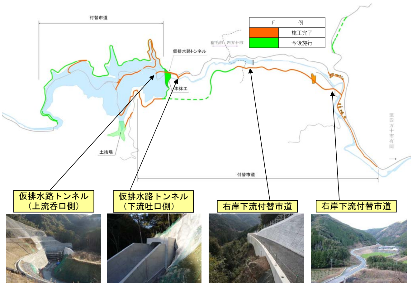
図 3-2-6 横瀬川ダム建設事業の進捗状況
