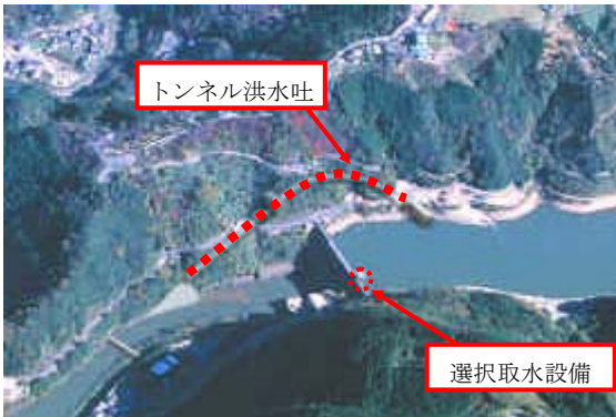
写真 2.4.3 鹿野川ダム施設改造イメージ
