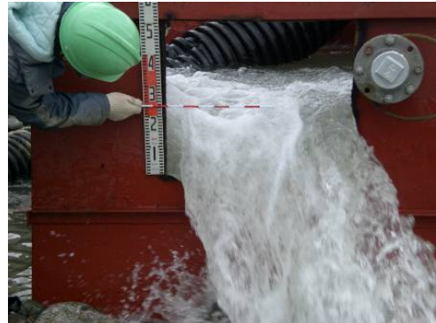
排水量の三角堰による測定状況
