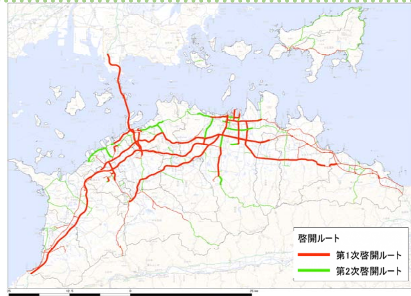
この地図は、国土地理院の地理院地図を加工して作成している。 図 香川県道路啓開計画 啓開ルート
