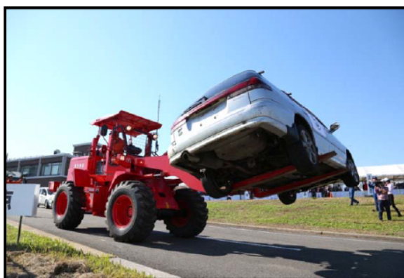
写真 フォークリフトアタッチメント付ホイールローダーによる車両移動
