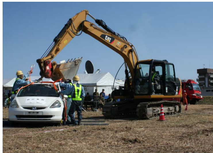
写真 バックホウによる吊上げ移動(イメージ)
