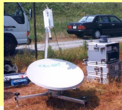
衛星小型画像伝送装置 (Ku-SAT)
