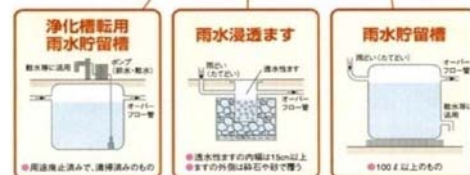
各戸貯留浸透施設のイメージ
