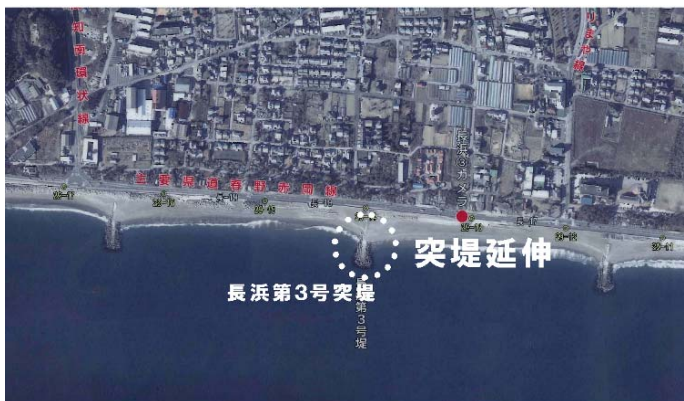
長浜工区における突堤延伸
