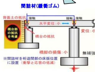
変位拘束工法による対策(イメージ)
