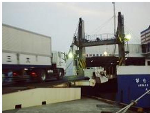
RoRo船による荷役状況
