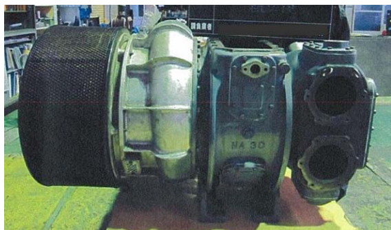
過給機本体の分解整備
